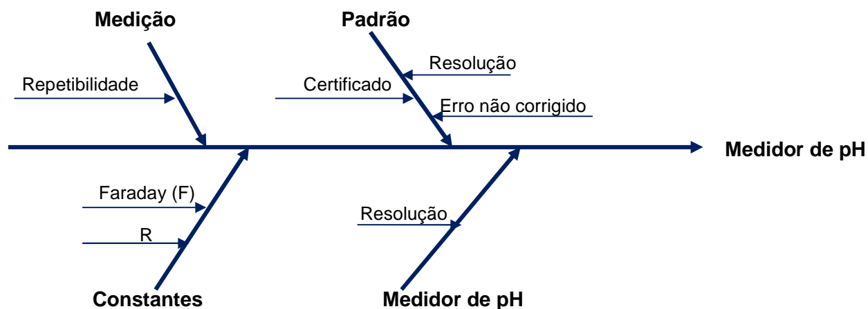
Figura 2. Diagrama de causa e efeito para a calibração elétrica de medidor de pH na função pH.
